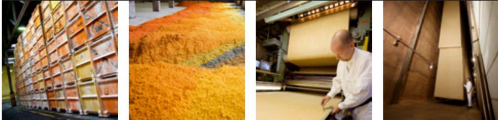
**Étape 1** L'huile de lin et la résine sont mélangées dans des fûts d'oxydation. Cela donne naissance à un « ciment de linoléum », la base spongieuse du Marmoleum.
